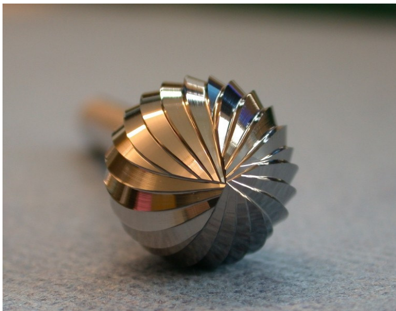
Figura N°6- Particolare dei denti in prossimità dell'asse di una lima con profilo a testa sferica (cortesia ditta CERIN – Affi- VR)
